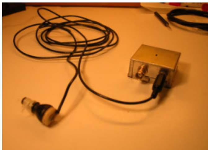
Figur 16 – Komplet opstilling med modificeret mundstykke og mikrofontilslutningsboks.
