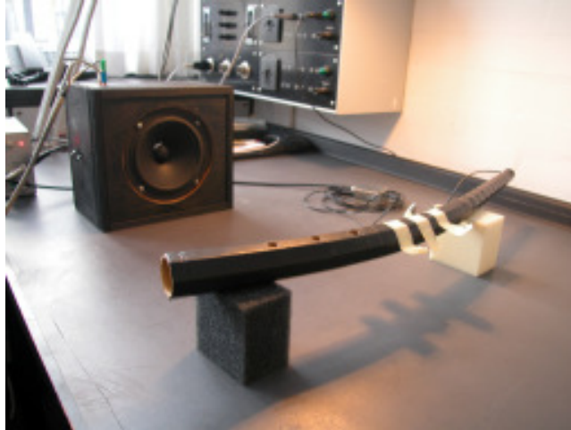
Figur 24 – Drivning af zinken fra siden af instrumentet. Afstanden mellem højttaler og zink var cirka 400 mm og afstanden til bordet cirka 70 mm.
