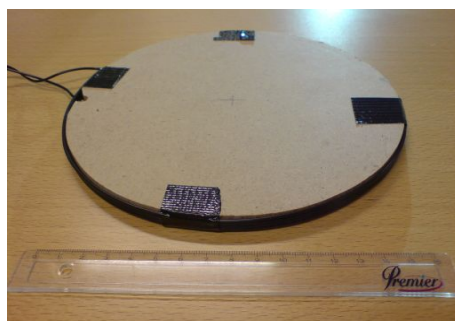
Figur 4 – Skiveformet spole viklet med fire vindinger af isoleret tråd på en cirkulær træform med diameteren 0,179 m og 1 m længde af tilslutningen, der er løst snoet for at mindske det uundgåelige bidrag. Selvinduktionen er målt til 7,9 \mu\text{H} på en målebro ved 10 kHz.
