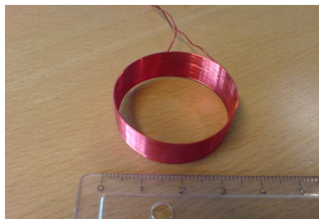
Figur 6 – Kort cylindriske spole med 25 vindinger, tråddykkelsen 0,5\text{ mm} og en indre diameter på 32\text{ mm} . Leverandøren har oplyst den målte selvinduktion for to spoler til 24,2 og 24,5\ \mu\text{H} , så gennemsnittet er L = 24,35\ \mu\text{H} med en variation på \pm 0,15\ \mu\text{H} , hvilket indikerer at præcisionen af målingen kan forventes at være ringere end \pm 0,6\% .
