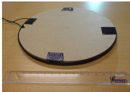
Figur 5 – Skiveformet spole viklet med isoleret tråd på en cirkulær træform.
