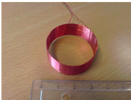
Figur 6 – Kort cylinderspole fra Coil Craft med opgivet selvinduktion på 24,35 \mu\text{H} .
