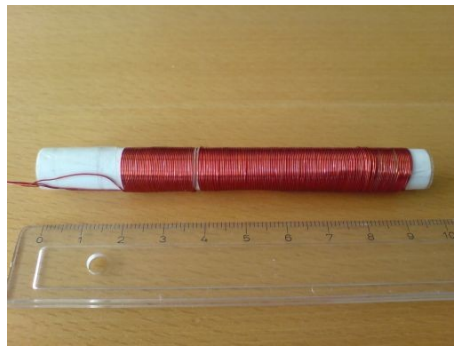
Figur 7 – Lang cylinderspole med målt selvinduktion på 65 \mu\text{H} for begge spolens sektioner.
